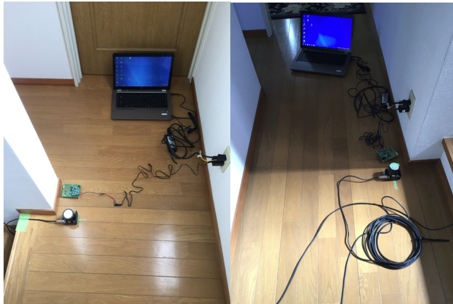
図 5 据え置き型振動センサの設置
